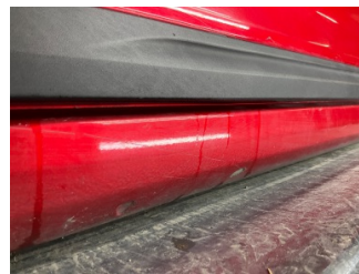
Marşbiyel, sol, Marşbiyel, sol > Boyası Atmış
