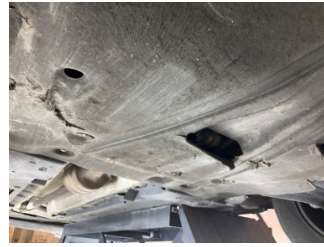
Motor, Alt muhafaza > Hasarlı
