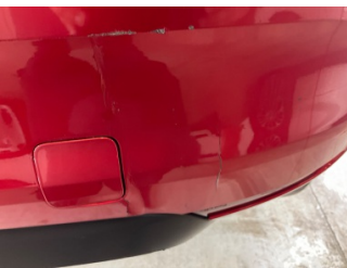
Tampon, arka, Arka tampon > Çatlak
