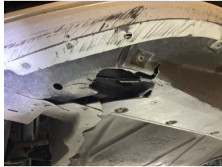
Tampon, ön, Tampon koruyucu orta > Hasarlı
