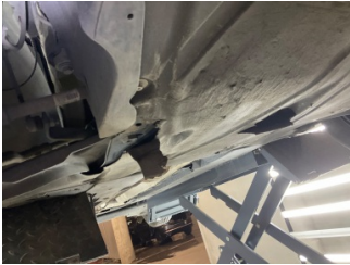
Motor, Alt muhafaza > Hasarlı
