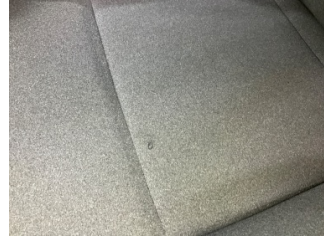
Döşemeler/Kapaklar, Döşemeler/Kapaklar > Yakıcı Madde Ile Zarar Görmüş
