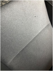
Döşemeler/Kapaklar, Döşemeler/Kapaklar > Yakıcı Madde Ile Zarar Görmüş
