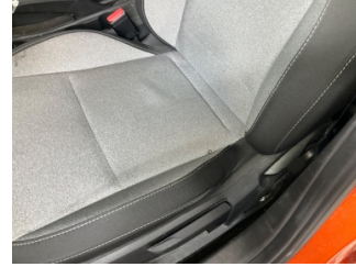
Döşemeler/Kapaklar, Döşemeler/Kapaklar > Yakıcı Madde Ile Zarar Görmüş
