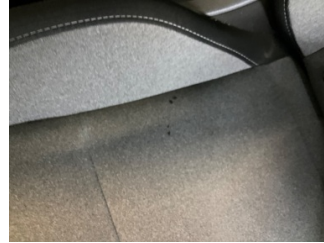
Döşemeler/Kapaklar, Döşemeler/Kapaklar > Yakıcı Madde Ile Zarar Görmüş
