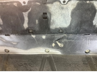
Tampon, ön, Tampon koruyucu orta > Hasarlı
