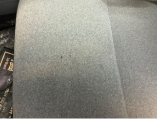
Döşemeler/Kapaklar, Döşemeler/Kapaklar > Yakıcı Madde Ile Zarar Görmüş
