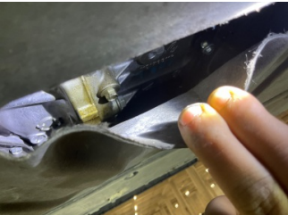
Motor, Motor > Yağ Kaçağı
