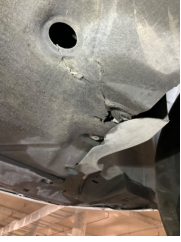
Motor, Alt muhafaza > Hasarlı
