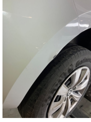
Tampon, arka, Arka tampon > Küçük Çizik
