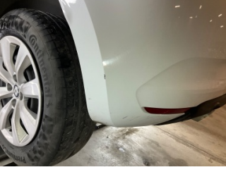
Tampon, arka, Arka tampon > Küçük Çizik
