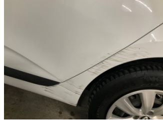
Kapı, sol arka, Kapı, sol arka > Çizik
