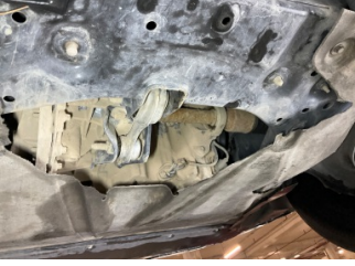
Motor, Alt muhafaza > Hasarlı
