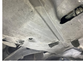
Motor, Alt muhafaza > Hasarlı
