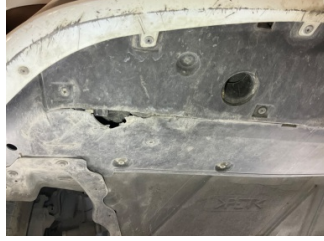
Tampon, ön, Tampon koruyucu orta > Hasarlı
