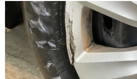
Jant kapağı, sağ ön > Hasarlı
