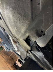
Motor, Alt muhafaza > Hasarlı
