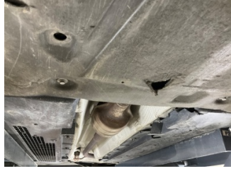
Motor, Alt muhafaza > Hasarlı
