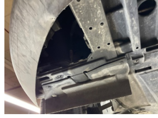
Tampon, ön, Tampon koruyucu sağ > Eksik
