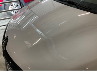
Motor kaputu, Motor kaputu > Dolu Hasarı
