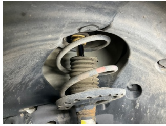
Ön aks, Amortisör körüğü, sol > Hasarlı
