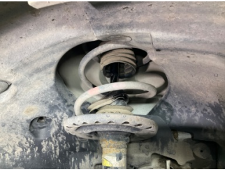
Ön aks, Amortisör körüğü, sağ > Hasarlı
