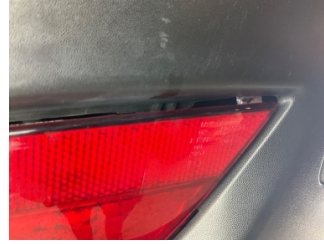
Tampon, arka, Reflektör, sol > Sabitlemesi Hatalı
