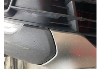
Tampon, ön, Spoiler > Hasarlı
