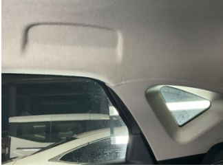
Döşemeler/Kapaklar, Döşemeler/Kapaklar > Deforme Olmuş
