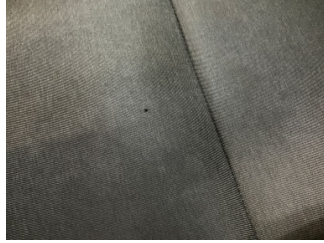
Döşemeler/Kapaklar, Döşemeler/Kapaklar > Yakıcı Madde ile Zarar Görmüş
