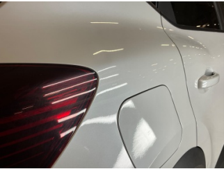
Çamurluk, sağ arka, Çamurluk, sağ arka > Ezik
