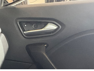
Kapı, sağ ön, Kapı kolu, iç > Onaysız
