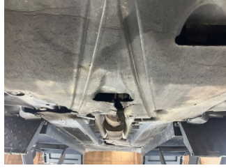
Motor, Alt muhafaza > Hasarlı
