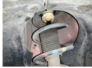
Ön aks, Amortisör körüğü, sol > Hasarlı
