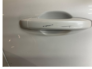
Kapı, sağ arka, Kapı kolu, dış > Çizik
