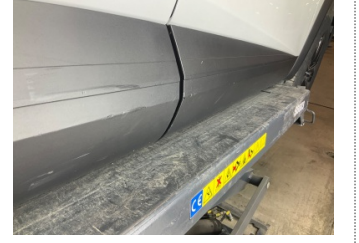
Kapı, sağ ön, Kapı bandı > Çizik
