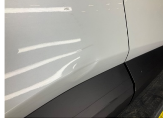
Kapı, sağ arka, Kapı, sağ arka > Ezik
