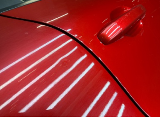
Kapı, sağ arka, Kapı, sağ arka > Ezik
