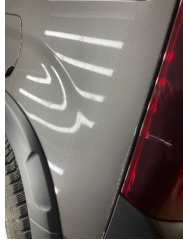
Çamurluk, sol arka, Çamurluk, sol arka > Çizik
