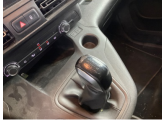
Şanzıman, Vites topuzu > Deforme Olmuş
