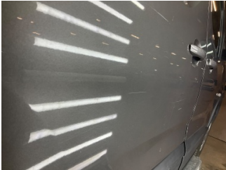
Kapı, sağ arka, Kapı, sağ arka > Çizik
