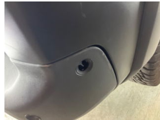
Tampon, arka, Park sensörü, sağ > Sökülmüş-Yok
