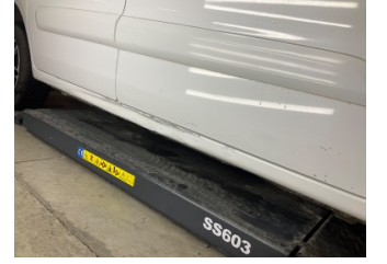
Marşbiyel, sağ, Marşbiyel, sağ > Hasarlı
