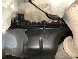
Motor, Motor > Yağ Kaçağı
