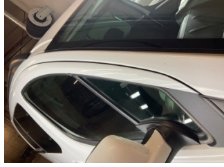
Tavan, Ön cam direği, sağ > Boyası Atmış
