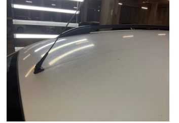
Tavan, Tavan > Dolu Hasarlı
