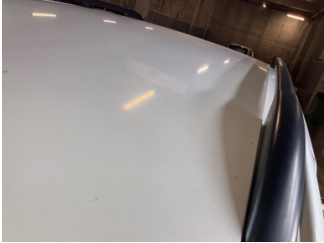
Tavan, Tavan > Dolu Hasarlı
