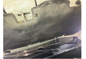
Motor, Motor izolasyonu > Hasarlı
