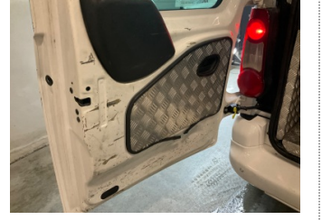
Bagaj kapağı/kapısı, Bagaj kapısı > Ezik
