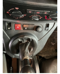
Şanzıman, Vites körüğü > Hasarlı
