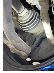
Ön aks, Aks mili, toz körüğü, sağ > Yağ Kaçağı
