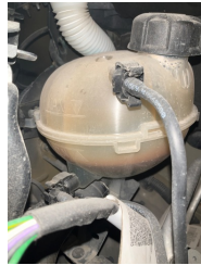
Motorsoğutması, Soğutma sıvısı > Eksik
