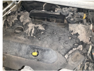
Motor, Motor üst kapağı, plastik > Deforme Olmuş
