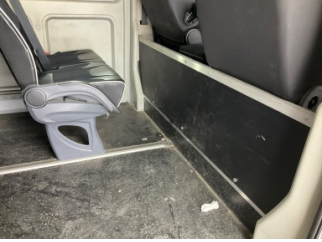
Döşemeler/Kapaklar, Döşemeler/Kapaklar > Deforme Olmuş
