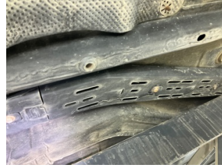
Kaporta, Muhafaza, orta > Hasarlı
