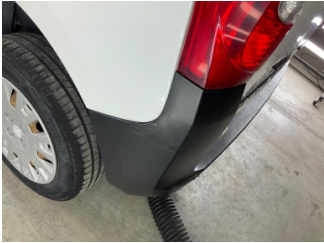
Tampon, arka, Arka tampon > Sabitlemesi Hatalı
