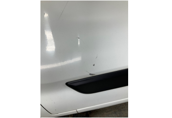
Kapı, sol ön, Kapı, sol ön > Boyası Atmış
