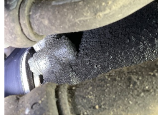
Motor, Motor > Yağ Kaçağı
