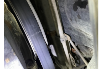
Motorsöğütması, Kayış > Çatlak
