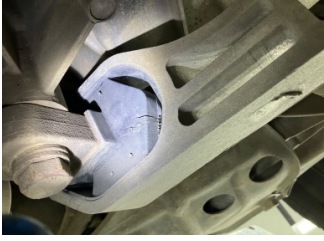
Şanzıman, Şanzıman askısı > Hasarlı
