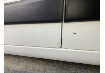
Kapı, sol ön, Kapı, sol ön > Vuruk
