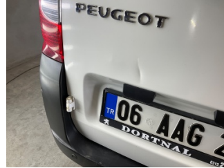
Bagaj kapağı/kapısı, Bagaj kapısı > Ezik
