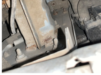
Kaporta, Sol Ön Şase > Boyası Atmış
