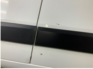
Kapı, sol arka, Kapı, sol arka > Boyası Atmış
