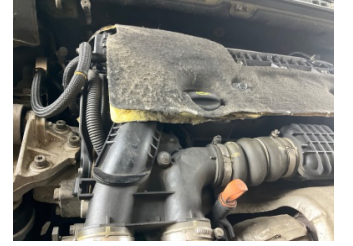
Motor, Motor üst kapağı, plastik > Hasarlı
