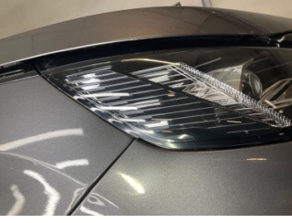
Farlar, Far camı, sağ > Deforme Olmuş
