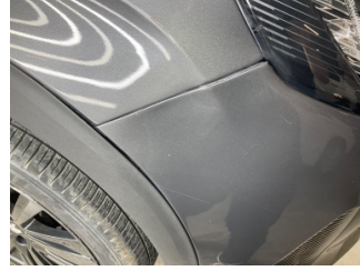
Tampon, ön, Ön tampon > Sabitlenmesi Hatalı
