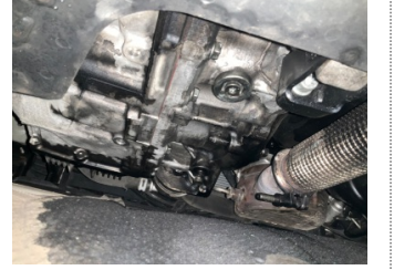
Şanzıman, Şanzıman > Yağ Kaçağı
