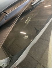
Camlar, Ön cam > Çatlak
