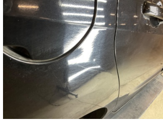
Çamurluk, sağ arka, Çamurluk, sağ arka > Ezik
