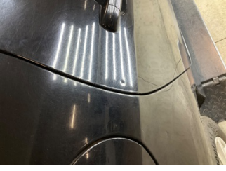
Kapı, sağ arka, Kapı, sağ arka > Ezik
