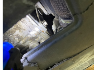
Şanzıman, Şanzıman > Yağ Kaçağı
