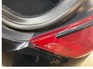
Arka lambalar, Arka lamba camı, sağ > Hasarlı
