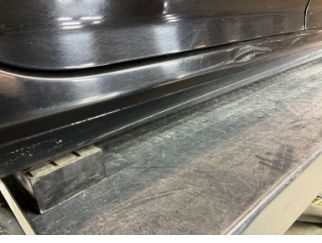
Marşbiyel, sağ, Marşbiyel, sağ > Hasarlı
