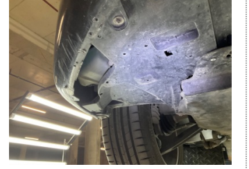
Tampon, ön, Tampon koruyucu orta > Hasarlı
