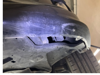
Tampon, ön, Tampon koruyucu orta > Hasarlı
