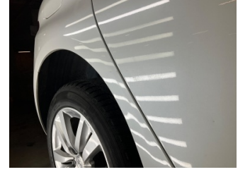
Çamurluk, sağ arka, Çamurluk, sağ arka > Küçük Vuruk
