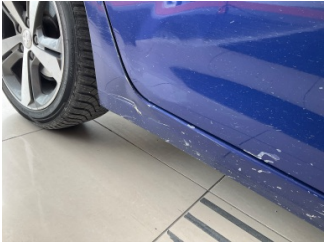
Marşbiyel, sağ, Marşbiyel, sağ > Hasarlı
