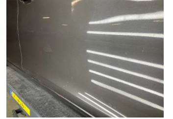
Kapı, sağ ön, Kapı, sağ ön > Çizik
