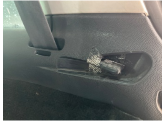
Döşemeler/Kapaklar, Pandizot > Standart Dışı Onarım
