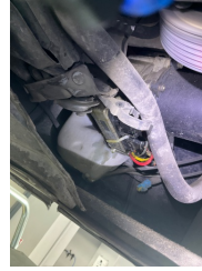
Direksiyon sistemi, Hidrolik pompası > Yağ Kaçağı
