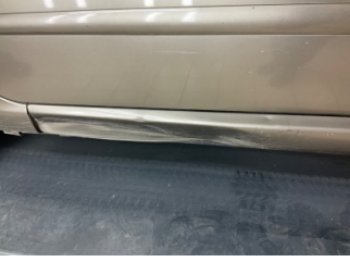
Marşbiyel, sol, Marşbiyel, sol > Hasarlı
