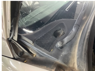
Camlar, Alt Izgara > Hasarlı
