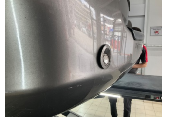
Tampon, arka, Park sensörü, sol > Sabitlemesi Hatalı
