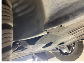
Çamurluk, sağ, Davlumbaz > Kırılmış
