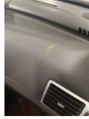
Pano/Göstergeler, Pano, sağ > Hasarlı
