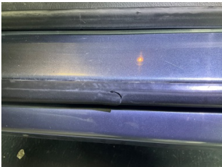
Kapı, sol ön, Kapı fitili > Hasarlı
