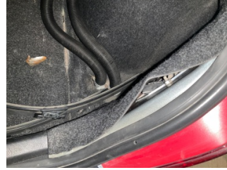
Döşemeler/Kapaklar, Bagaj kapağı, iç döşemesi > Sabitlemesi Hatalı
