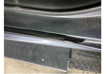
Kapı, sol arka, Kapı fitili > Sabitlemesi Hatalı
