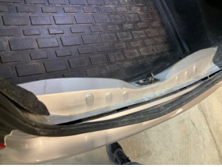
Döşemeler/Kapaklar, Yükleme eşiği kaplaması > Çizik
