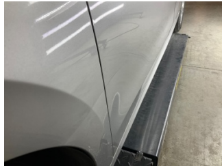
Kapı, sol ön, Kapı, sol ön > Ezik
