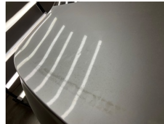
Bagaj kapağı/kapısı, Bagaj kapısı > Noktasal Ezik
