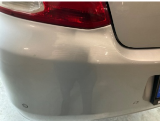
Tampon, arka, Arka tampon > Çatlak
