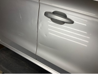
Kapı, sağ ön, Kapı, sağ ön > Hasarlı
