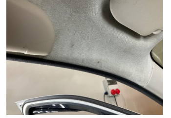
Döşemeler/Kapaklar, Döşemeler/Kapaklar > Yakıcı Madde ile Zarar Görmüş
