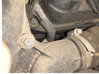
Motor, Külbütör kapağı > Yağ Kaçağı
