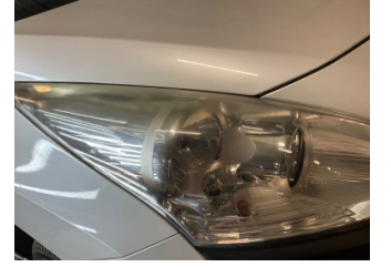
Farlar, Far camı, sağ > Deforme Olmuş
