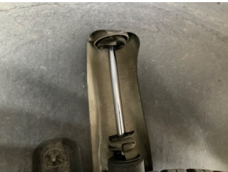
Arka aks, Amortisör körüğü, sol > Hasarlı
