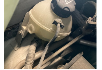
Motorsoğutması, Soğutma sıvısı > Eksik
