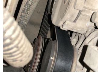
Motorsoğutması, Kayış > Çatlak
