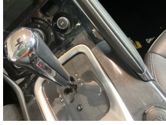
Şanzıman, Vites topuzu > Deforme Olmuş
