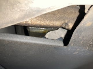
Şanzıman, Şanzıman yağı > Yağ Kaçağı
