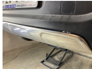
Tampon, arka, Spoiler > Sabitlemesi Hatalı
