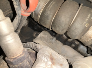
Motor, Külbütör kapağı > Yağ Kaçağı
