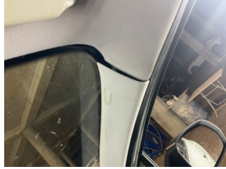
Döşemeler/Kapaklar, Döşemeler/Kapaklar > Sabitlemesi Hatalı
