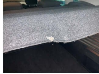
Döşemeler/Kapaklar, Pandizot > Deforme Olmuş
