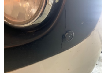
Tampon, ön, Park sensörü, sol > Hasarlı
