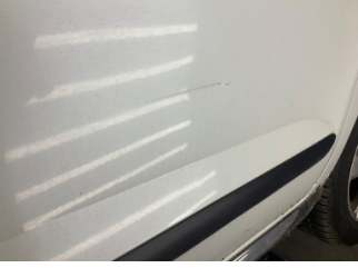
Kapı, sağ ön, Kapı, sağ ön > Çizik
