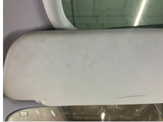
Döşemeler/Kapaklar, Döşemeler/Kapaklar > Kirlenmiş
