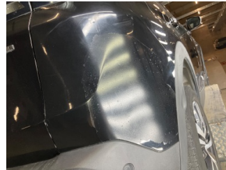
Tampon, arka, Arka tampon > Boyası Atmış
