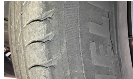
Tekerlek seti > Çatlak
