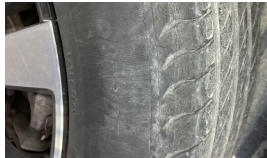
Tekerlek seti > Çatlak
