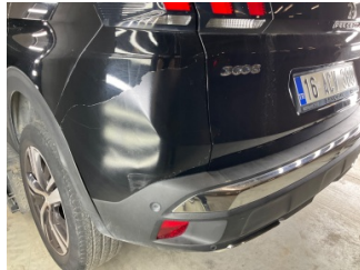
Tampon, arka, Arka tampon > Boyası Atmış
