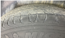
Tekerlek seti > Çatlak
