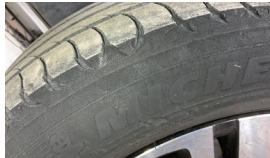
Tekerlek seti > Çatlak
