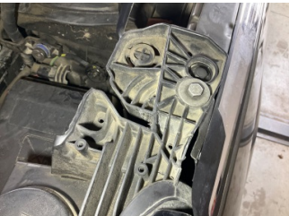
Farlar, Far bağlantı ayağı, sol > Hasarlı
