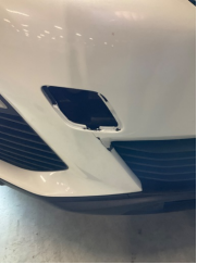
Tampon, ön, Çeki demir kapağı > Sökülmüş-Yok
