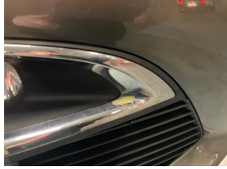
Sis lambaları, Sis Izgarası Sağ > Deforme Olmuş
