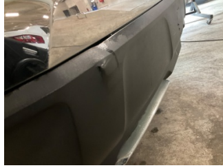
Tampon, arka, Spoiler > Kırılmış
