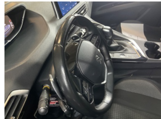
Direksiyon sistemi, Direksiyon simidi > Deforme Olmuş
