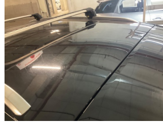
Tavan, Tavan > Dolu Hasarı
