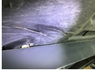
Kaporta, Muhafaza, orta > Hasarlı
