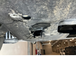
Motor, Alt muhafaza > Hasarlı
