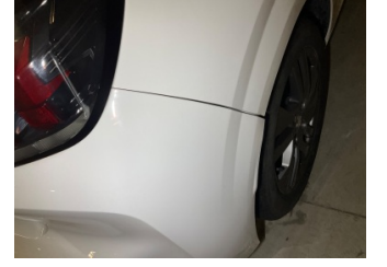
Tampon, arka, Arka tampon > Sabitlemesi Hatalı
