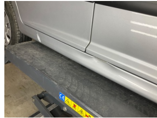
Marşbiyel, sağ, Marşbiyel, sağ > Hasarlı
