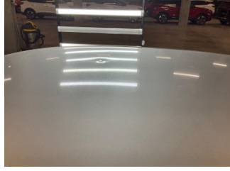
Tavan, Tavan > Dolu Hasarı
