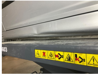
Marşbiyel, sol, Marşbiyel plastiği, sol > Hasarlı
