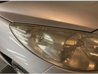
Farlar, Far camı, sağ > Deforme Olmuş
