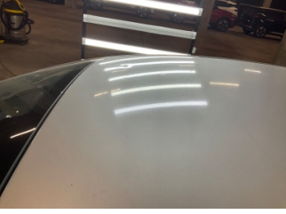
Tavan, Tavan > Dolu Hasarı
