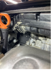
Motor, Motor > Yağ Kaçağı
