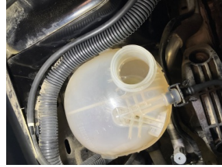
Motorsoğutması, Soğutma sıvısı > Eksik
