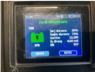
Elektrik donanımı/Pano, Akü > Test Sonucu
