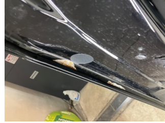
Kapı, sol ön, Kapı, sol > Boyası Atmış
