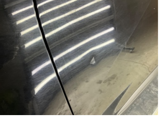
Kapı, sol ön, Kapı, sol > Ezik
