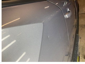
Kapı, sağ arka, Kapı, sağ arka > Ezik
