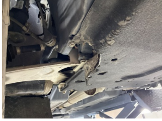
Motor, Alt muhafaza > Hasarlı
