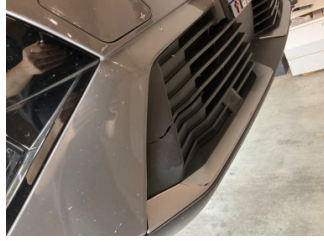
Tampon, ön, Ön tampon ızgarası > Hasarlı
