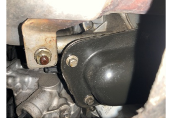
Motor, Motor > Yağ Kaçağı
