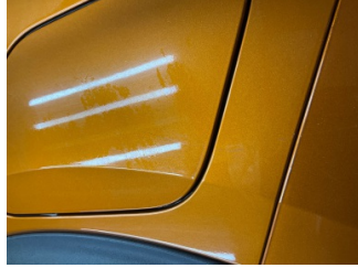
Çamurluk, sol arka, Çamurluk, sol arka > Çizik
