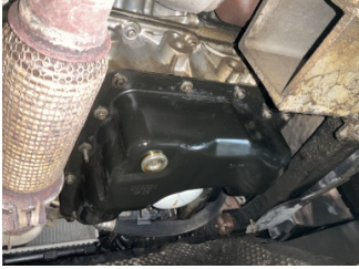
Motor, Motor > Yağ Kaçağı
