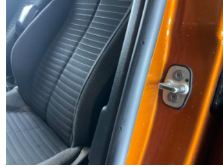
Kapı, sol ön, Kapı fitili > Hasarlı
